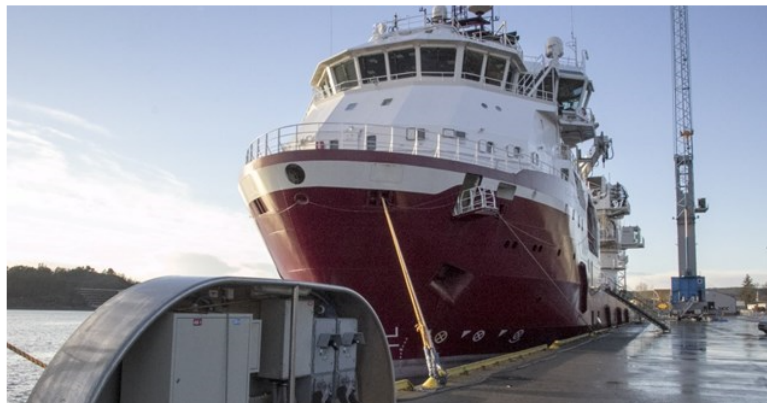
Skipet Dina Star får landstrøm i Kongsgårdukta i Kristiansand. Foto: Per-Kåre Sandbakk / NRK
